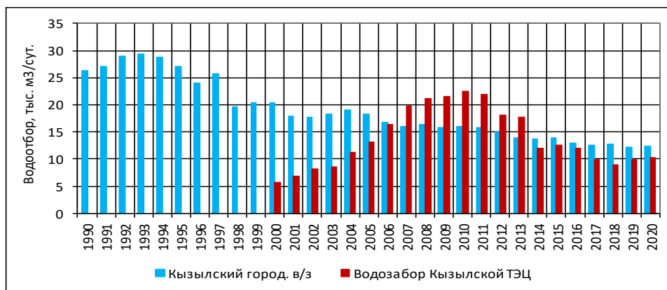
Рис. 3.3. Динамика изменения водоотбора на Кызылском городском водозаборе (ООО «Водоканал-Сервис») и водозаборе АО «Кызылская ТЭЦ»
